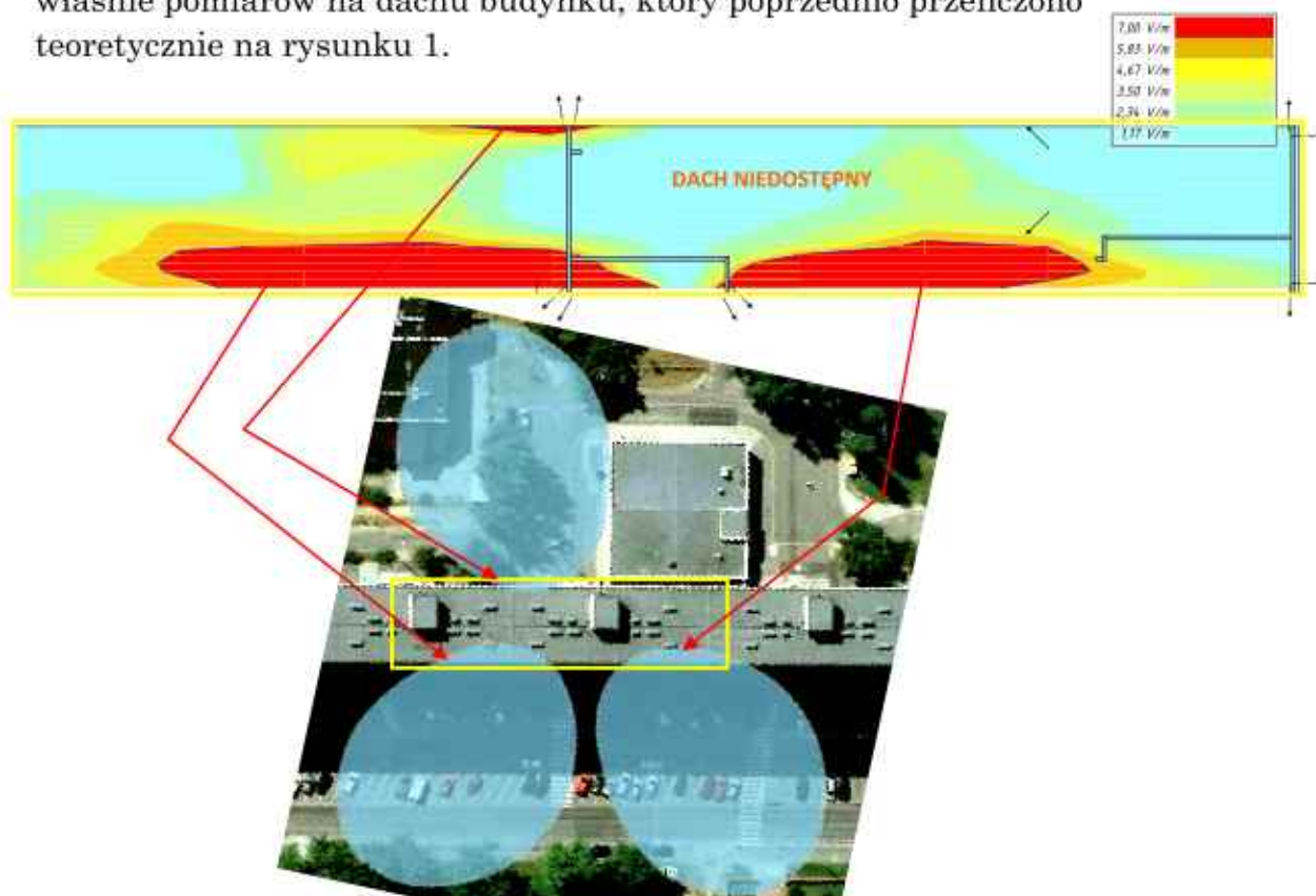
Rysunek 4. Mapka rzeczywistego rozkładu promieniowania od anten stacji bazowej na dachu tego samego bloku co na rysunkach 1 i 2; intensywny kolor czerwony oznacza pole o wartości niedopuszczalnej dla miejsc dostępnych. Na dolnym rysunku symulacja rozkładu pola zgodna z pomiarami.
